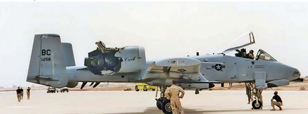
Мотор на америчком јуришнику А-10 који су оштетиле прошивничке ракете земља-ваздух
