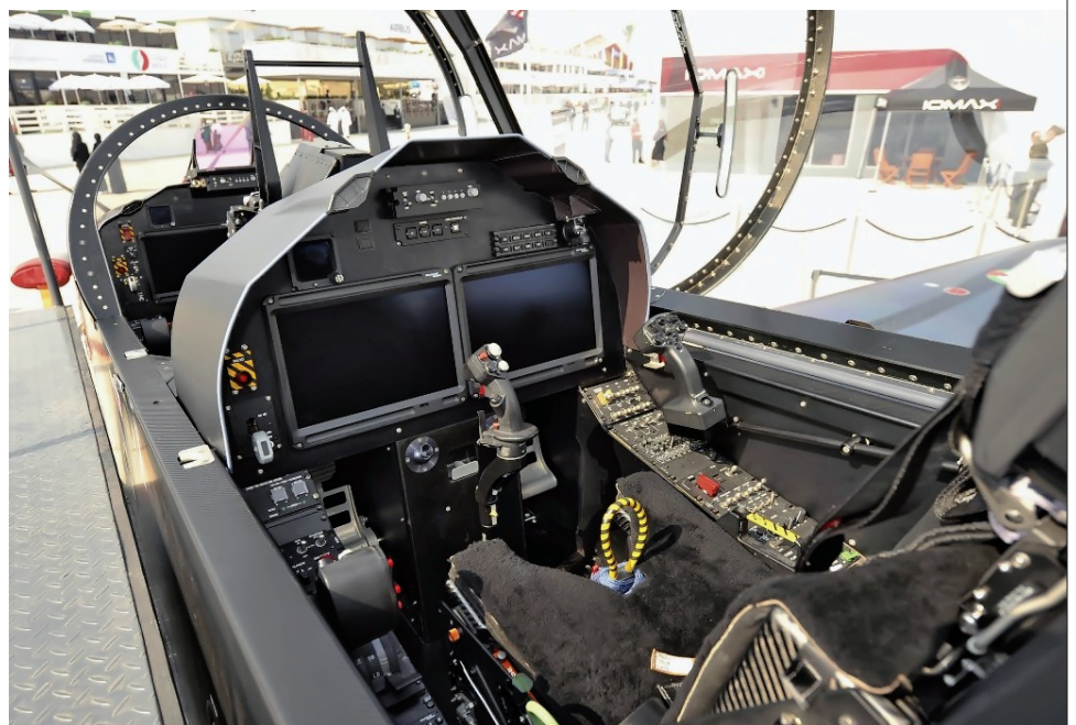
На авион су интегрисани савремена кабинска опрема и уређаји, укључујући и два велика показивача осетљива на додир
