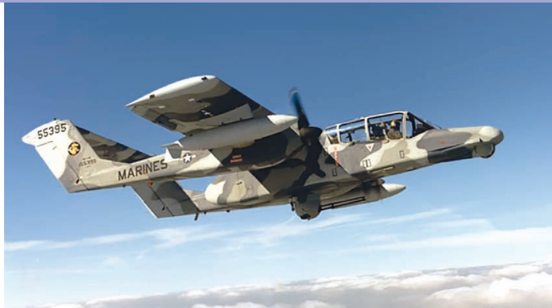
Прошлости YOV-10D Bronco NOGS (Night Observation Gunship System), врхунски опремљена варијанта OV-10 Bronco, са инфрацрвеном опремом за осматрање и нишањење, као и широким топом 20 mm у обртној шурели испод шпуреа. По многим овај је авион био врхунац међу COIN авионима, али никада није достигао њун пошенијал.
