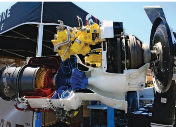
Турбоелисни TPE-331 са центрифугалним компресором нарочито опшорним на усисане чесице. Елиса се покреће посредством редуктора и није у осипора. Овакво решење обезбеђује уградњу централно моншираног мишраљеца или шора који гађа кроз обртно поље елисе пошупш ловаца из Другог свејског раша.
